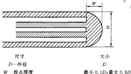
图2 接地型热电偶测量端纵截面图
