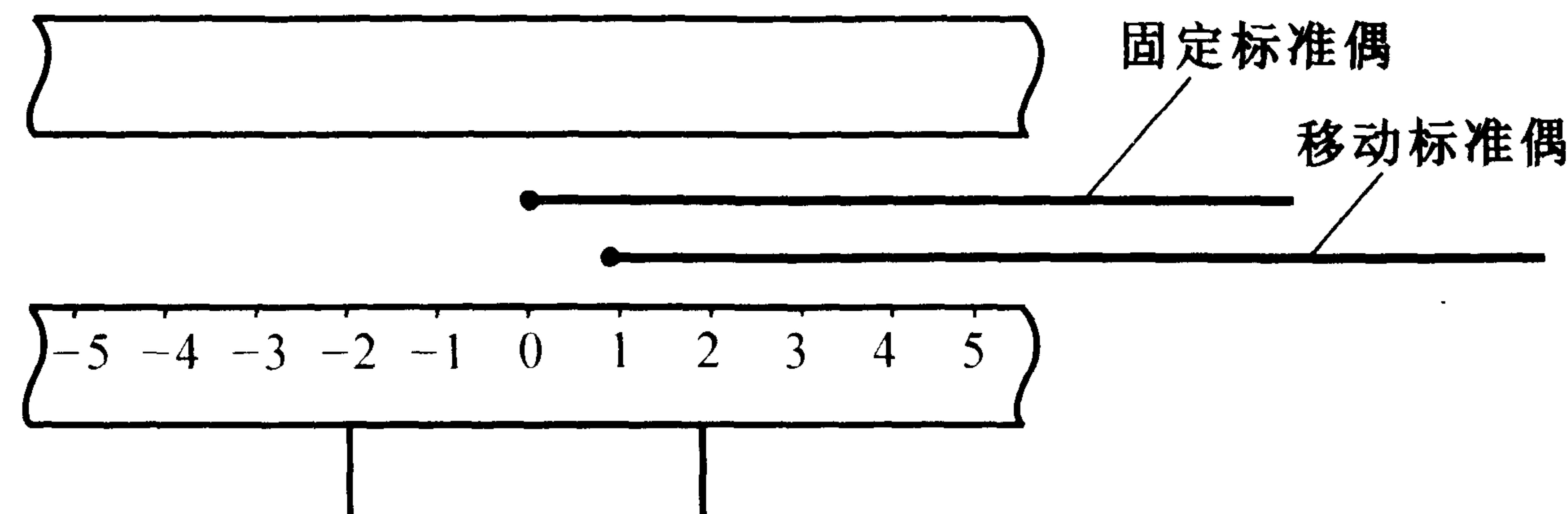
图 5 轴向温度场测试示意图
