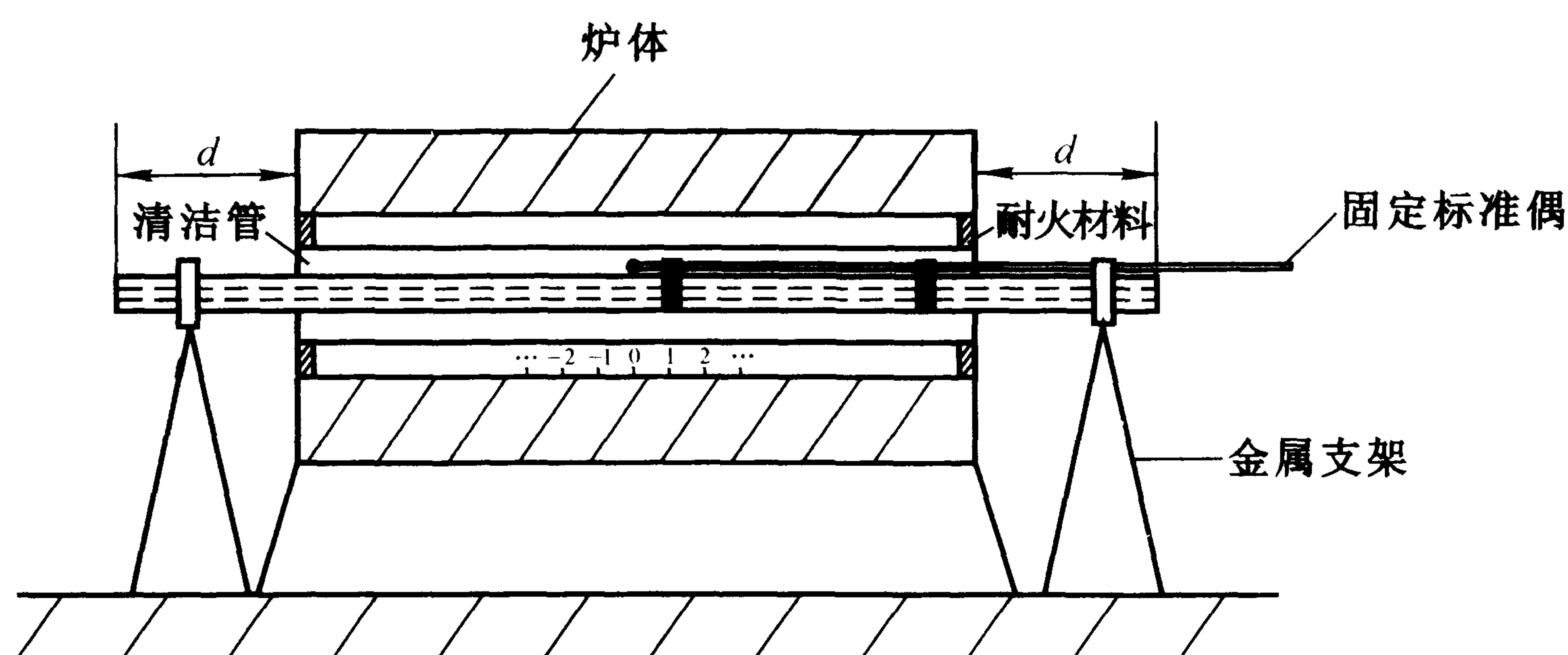
图 2 贵金属偶炉定位装置安装示意图
